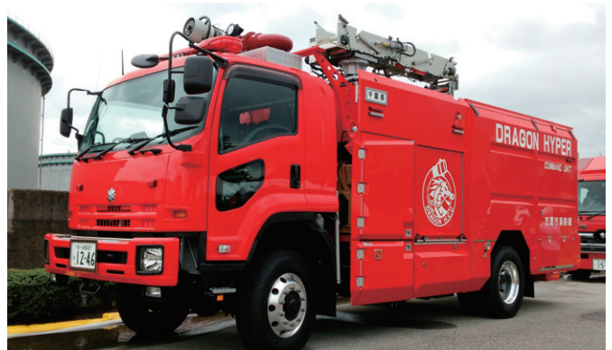
大型放水砲車（車両前方）
